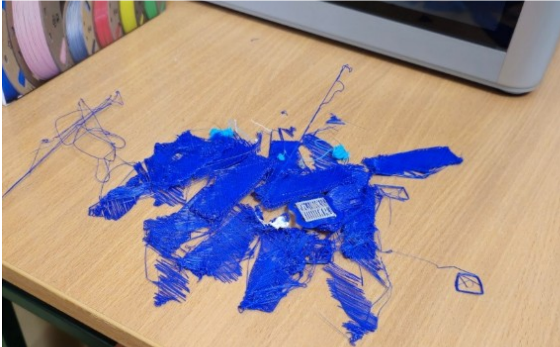
Hibás nyomtatás eredményei (Forrás: Saját szerkesztés)
