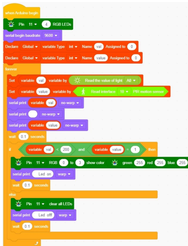
Figura 24: Estructura del bloque de control condicional para entrada analógica (Fuente: https://docs.keystudio.com )
