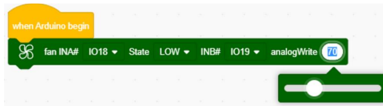
Figura 35: Diagrama blocului logic de control al ventilatorului (Sursa: https://docs.keystudio.com )
