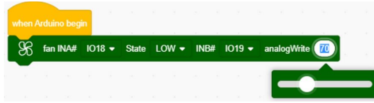
Şekil 35: Fan kontrol bloğu mantık diyagramı (Kaynak: https://docs.keyestudio.com )
