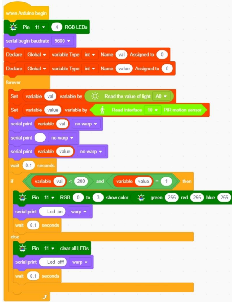
Şekil 24: Analog giriş için koşullu kontrol bloğu yapısı (Kaynak: https://docs.keyestudio.com )
