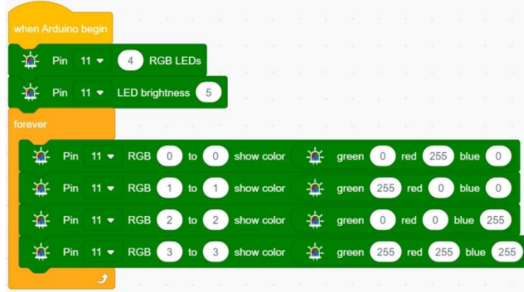
Şekil 22: Değişken kullanımına sahip bir aydınlatma kontrol bloğu programının tam yapısı (Kaynak: https://docs.keyestudio.com )
